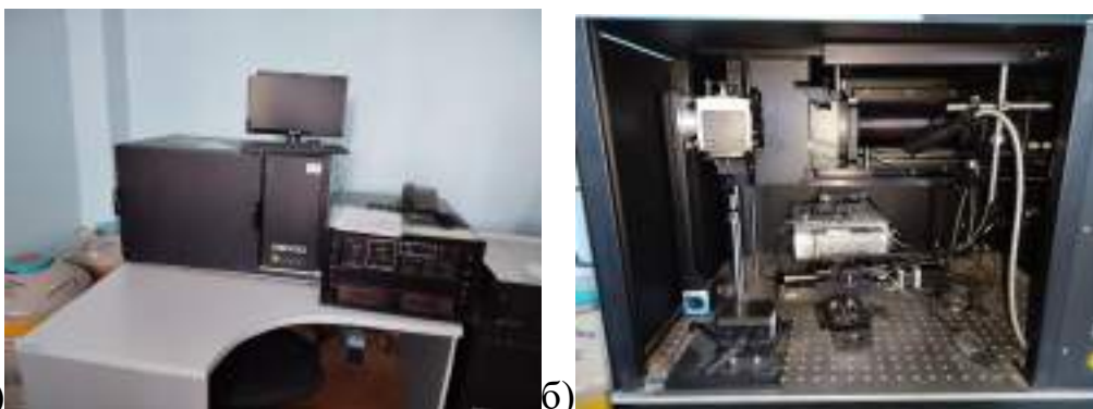
Рисунок 9 – Прибор QEX10, где а) Внешний вид прибора; б) внутренняя часть, где предоставлена система крепления для образцов
