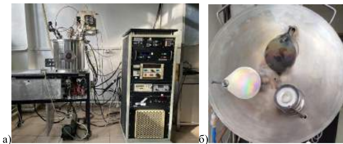
Рисунок 2 – Магнетронный распылитель система ARC2000 Series Sputtering System, где а) Сам аппарат; б) Мишень Sb закреплена в распылителе
